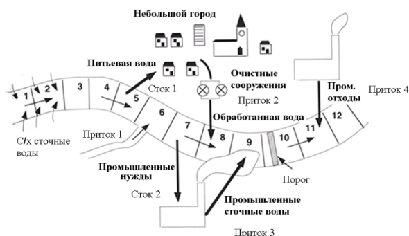
Рисунок 1. Схема типичных входных и выходных потоков реки города
